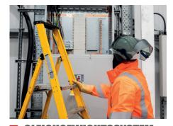
Das Gleichgewichtssystem ermöglicht ein sicheres Verstauen des Visiers für sicheres und komfortables Arbeiten. Das System unterstützt die Einhandbedienung und ermöglicht ein schnelles Anheben und Fixieren des Visiers über der Helmkrone für maximalen Arbeitsabstand.
