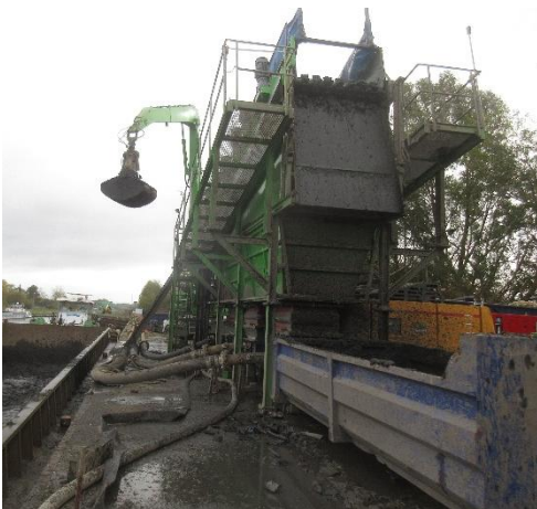
Sternsieb mit 1,7m Siebbreite als Schutzsieb für Kanalaushub- Förderpumpe. Es wird bei 60mm Durchmesser und maximal 180mm Länge gesiebt. Der Feinanteil wird mit 3 Betonpumpen 500 - 800m weit gefördert.
