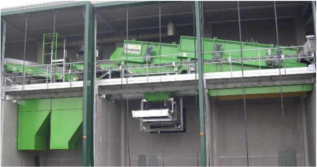
2 Sternsiebdecks in Reihe mit E-Antrieb.
