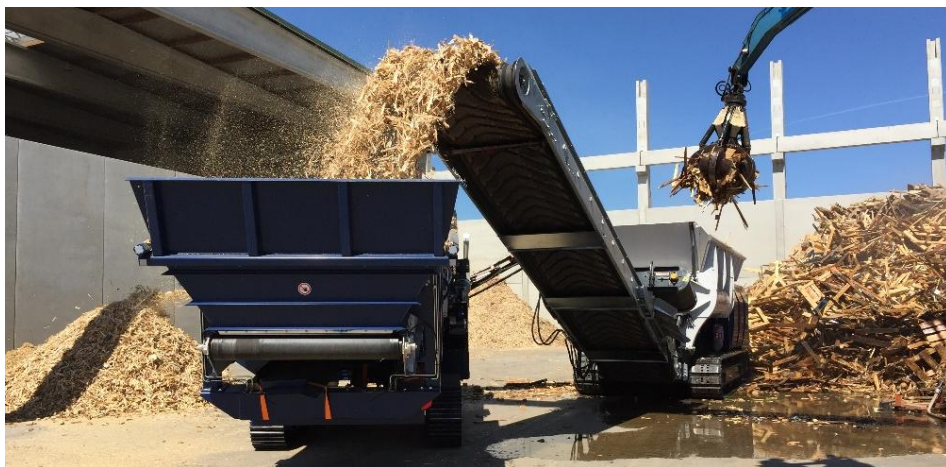
2 Wellenbrecher der Leistungsklasse 50t/h mit Sternsieb 2-tb17
