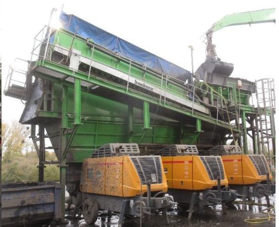
Sternsieb mit 1,7m Siebbreite als Schutzsieb für Kanalaushub- Förderpumpe. Es wird bei 60mm Durchmesser und maximal 180mm Länge gesiebt. Der Feinanteil wird mit 3 Betonpumpen 500 - 800m weit gefördert.
