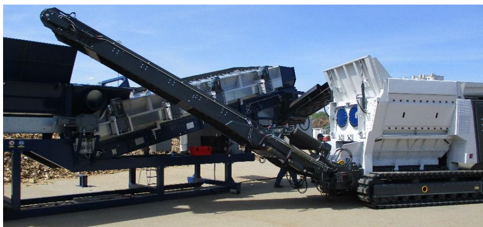
2 Wellenbrecher der Leistungsklasse 30t/h mit Sternsieb 2-sbe
